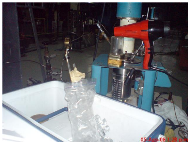
Figura N°24. Equipo de extracción acoplado al recipiente recolector de muestras
