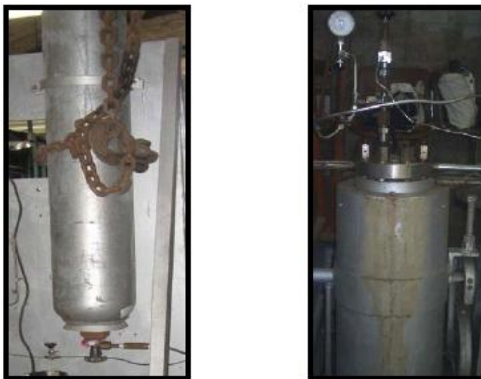
Figura N°22. A la izquierda: Bombona de CO2 Invertida. A la derecha: Recipiente de Alimentación y Presurizado.
