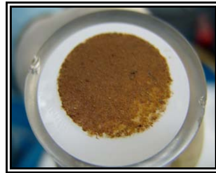
Figura 21. Papel de filtro de 0,45 \mu\text{m} con depósitos de carbonatos de calcio y materia orgánica
