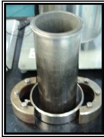
Figura 18. Montaje experimental del autoclave con agua de campo
