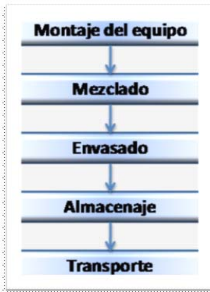
Figura 1. Esquema de preparación del inhibidor de incrustaciones a base de Aloe vera
