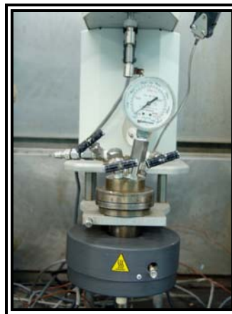
Figura 22. Montaje experimental del autoclave de inhibidores
