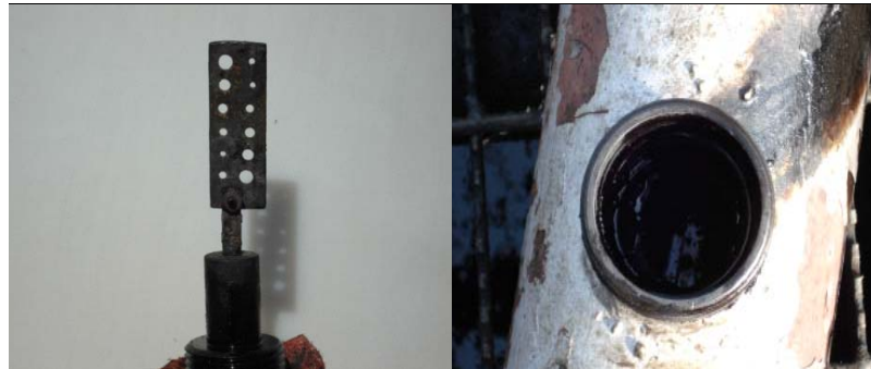
Figura 60. Estado del cupón y portacupón del pozo seleccionado a los 21 días transcurridos desde el inicio de la prueba de campo
