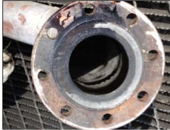
Figura 59. Estado del cabezal del pozo seleccionado en la División Centro Sur a los 21 días transcurridos desde el inicio de la prueba de campo
