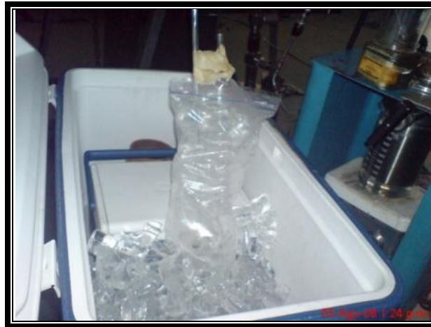
Figura 19. Fotografía del montaje del baño de hielo para el balón de separación de la grasa.
