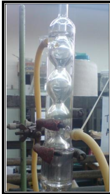
Figura 13. Fotografía del montaje de las mangueras en el equipo de extracción convencional.
