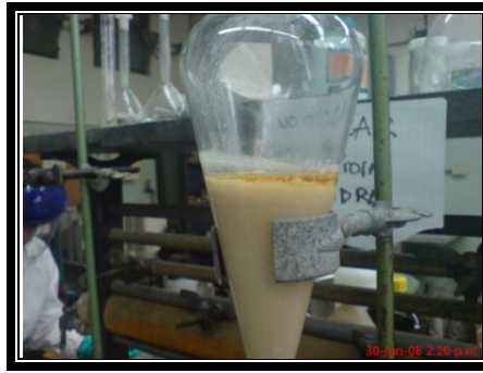
Figura 17. Fotografía del montaje del sistema de decantación luego de 24 horas usando etanol como solvente. .
