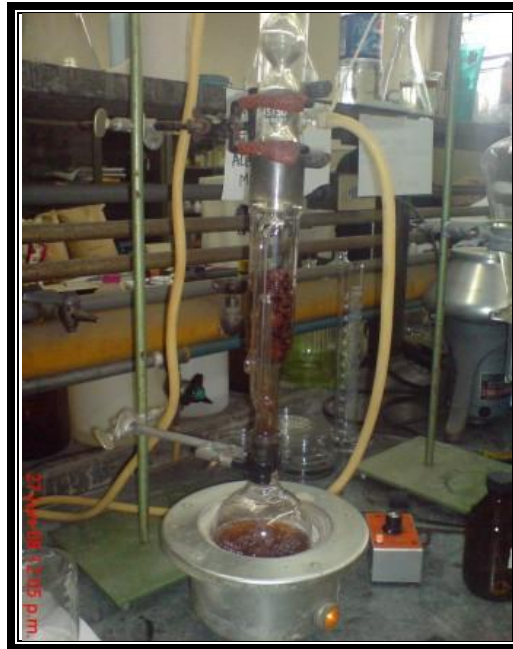
Figura 14. Fotografía del montaje final del equipo de extracción convencional.
