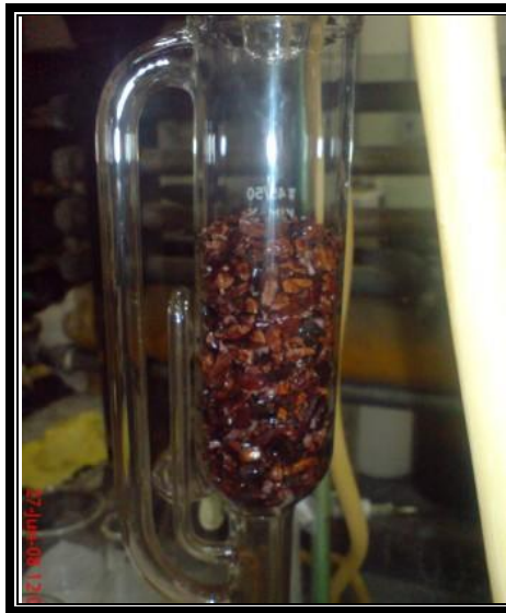
Figura 12. Fotografía de los granos dentro del extractor Soxhlet.
