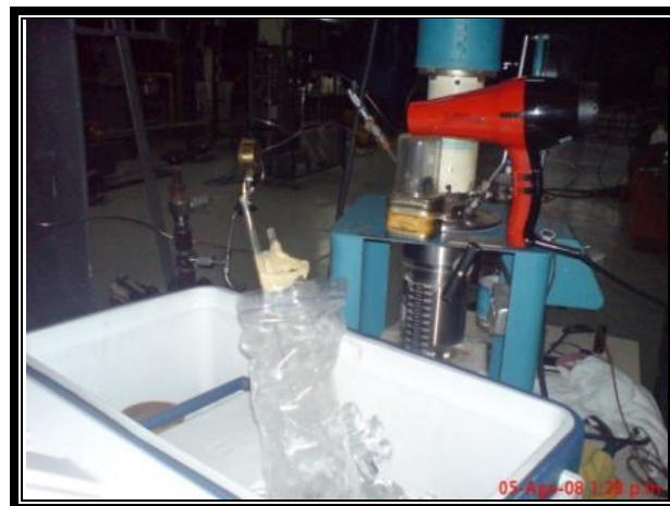
Figura 20. Fotografía del montaje del aire caliente para evitar el congelamiento de las tuberías de extracción.
