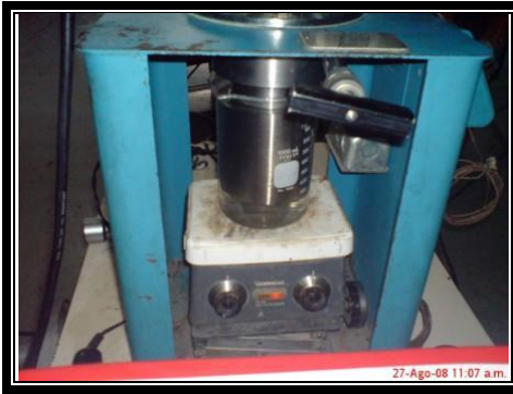
Figura 26. Fotografía del sistema de calentamiento para el reactor de extracción.
