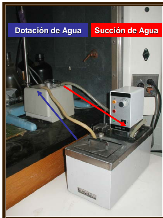
Figura 14: Conexión baño térmico y ultrasonidos
