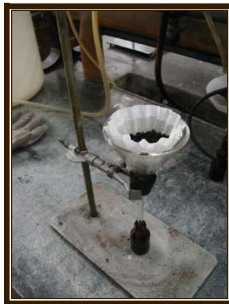
Figura 13: Montaje del equipo para recolección de muestra
