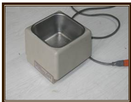
Figura 11: Equipo Ultrasonido utilizado para la extracción
