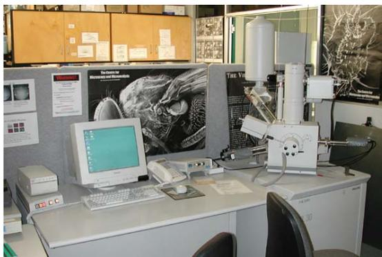
**Figura N°20:** Microscopio Electrónico de Barrido y Dispersión de Energía de Rayos X, Marca Philips Modelo XL-30
