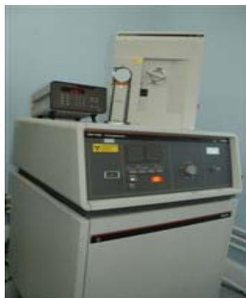
**Figura N°19:** Difractómetro de Rayos-X, Marca Philips, Modelo PW-1840.
