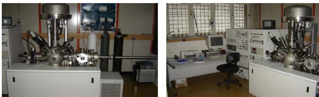
**Figura N°22:** Equipo de Espectroscopia Fotoelectrónica de Rayos X, Marca VG Scientific, Modelo ESCALAB 220i-XL
