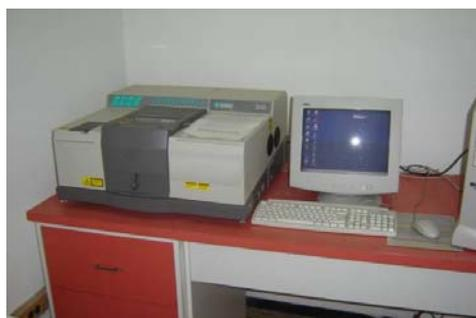
**Figura N°25:** Espectrómetro de Infrarrojo, Marca Spectrometor Perkin Elmer.
