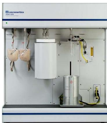
**Figura N°24:** Equipo de Adsorción Química de Hidrógeno, Marca Micromeritics, Modelo 2020C
