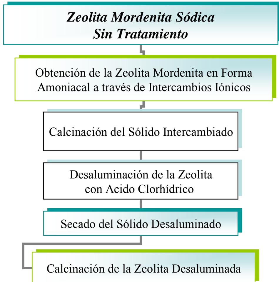
**Figura N° 10:** Esquema de las fases de modificación de la zeolita mordenita sódica
