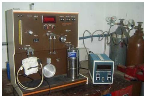
**Figura N°23:** Equipo de Adsorción Física de Nitrógeno, Marca Micromeritics, Modelo 2300
