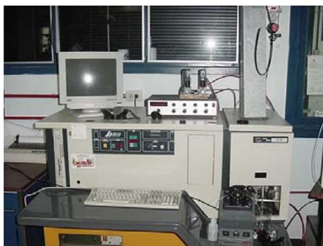
**Figura N°21:** Espectrómetro de Emisión Atómica con Plasma Acoplado Inductivamente (ICP), marca Jovin Yvon 24.
