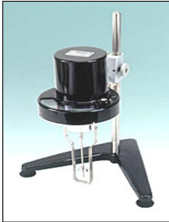
**Figura 20. Viscosímetro Rotacional Brookfield [Padrón A., Zúñiga P., 2005].**
