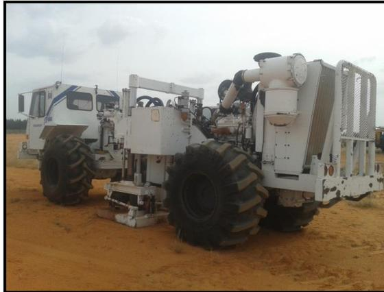
**Figura 21.** Fuente sísmica (fuente sísmica utilizada durante la adquisición de registro VSP en el pozo CMI-033-O).
