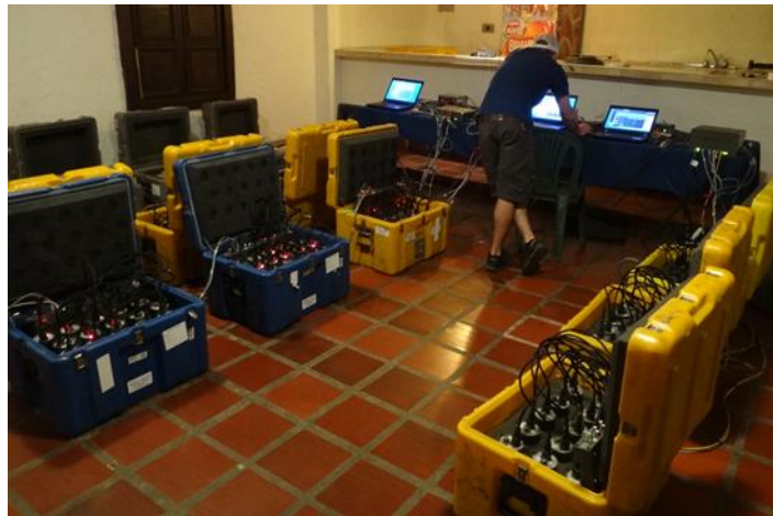
Figura 4.6 Descarga de datos y programación de texans.
