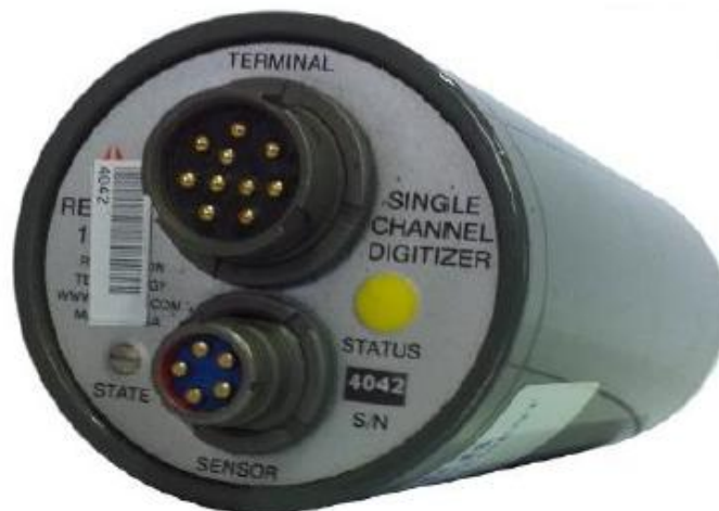
Figura 4.3 Sismógrafo independiente marca REF-TEK 125 a (texan).
