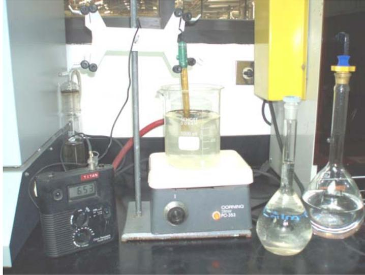
**Figura 3.1:** Montaje de ensayos de precipitación química
