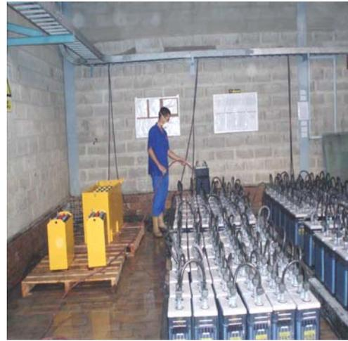
**Figura 4.16:** Llenado manual de baterías industriales.
