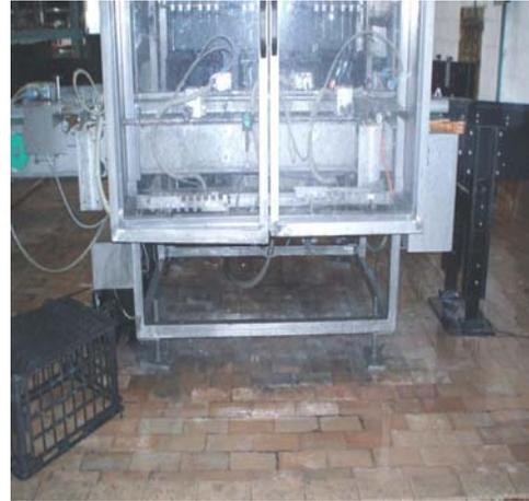
**Figura 4.10:** Derrame de ácido al piso en la máquina llenadora.
