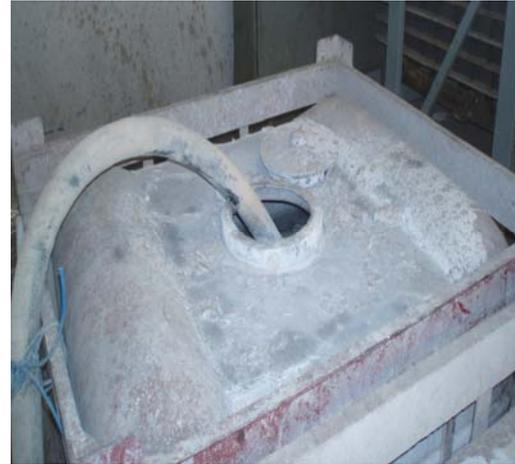
**Figura 4.7:** Sistema de succión de agua en los contenedores.
