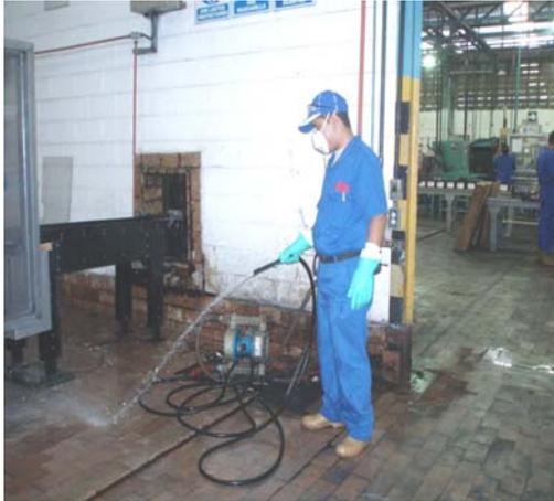
**Figura 4.9:** Lavado de pisos en el área de llenado.
