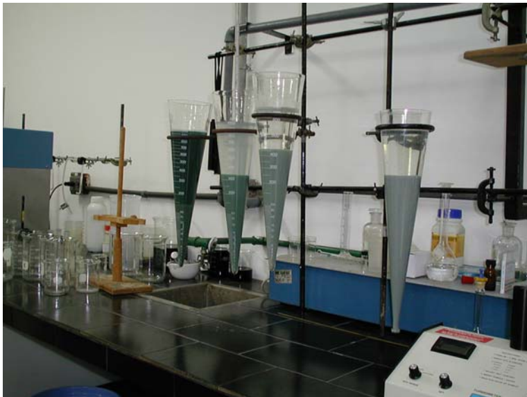
Figura Nº 3. Sedimentación en los conos Imhoff.
