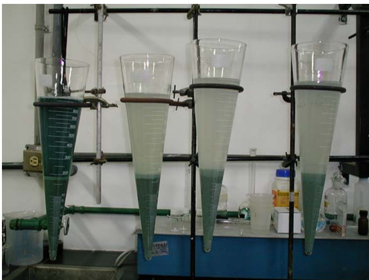
Figura N° 10. Precipitación con coagulantes en una muestra de la tenería El Puma C.A
