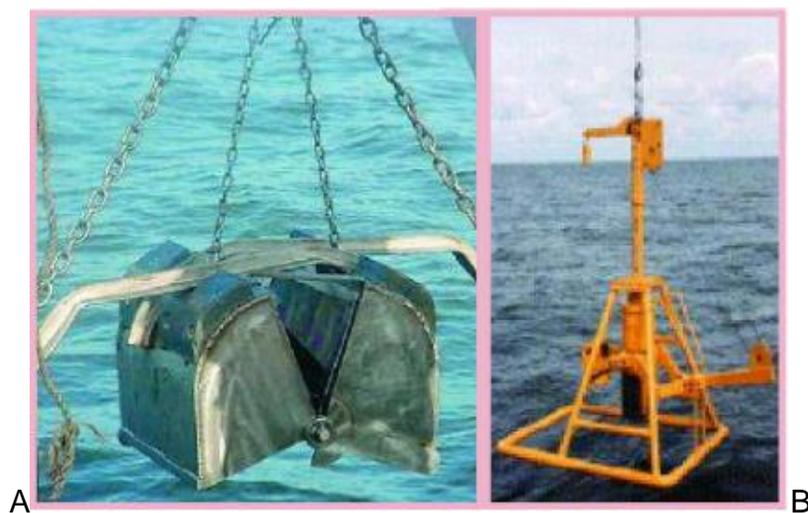
Figura # 5. Equipo de muestreo A) Draga Van Veen, B) Nucleador.<sup>[16]</sup>
