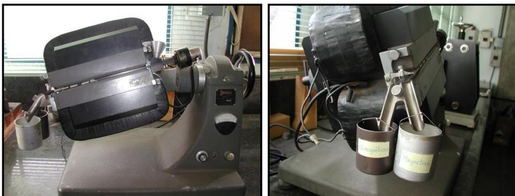
Figura # 8. Isodinámico de Frantz para la separación magnética de los minerales pesados.<sup>[14]</sup>
