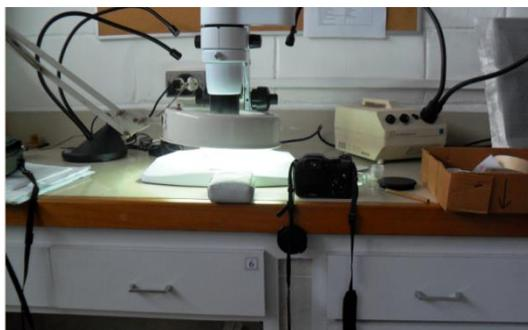
Figura # 9. Lupa binocular, marca Leica Mz 125.
