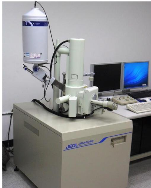
Figura # 10. Equipo de MEB marca JEOL JSM-6390
