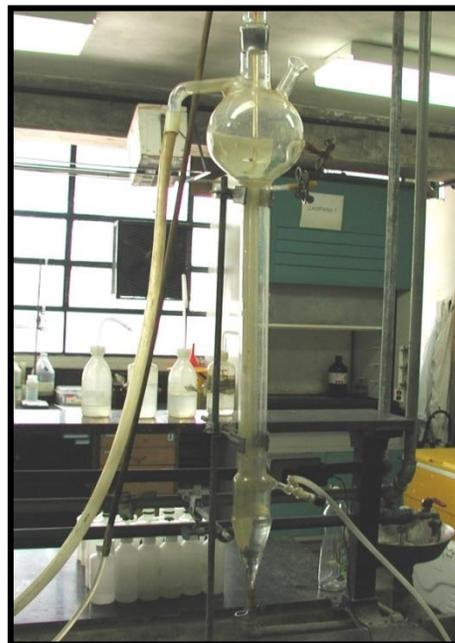
Figura # 7. Equipo empleado para la separación de los componentes pesados del sedimento por el método hidrodinámico.<sup>[14]</sup>
