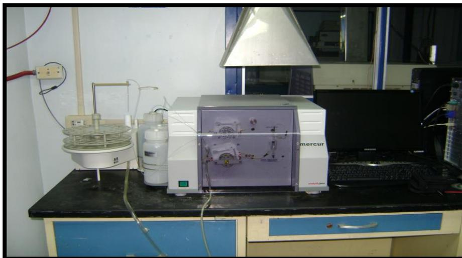
Figura 21. Espectrofotómetro de fluorescencia atómica con generación de vapor.
