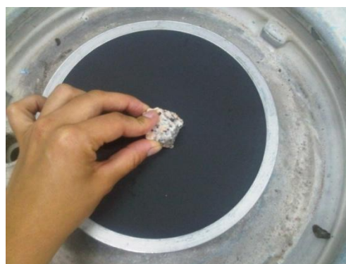
c) Proceso de eliminación de la pulitura del granito
