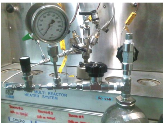
b) Montaje del cilindro con el reactor
