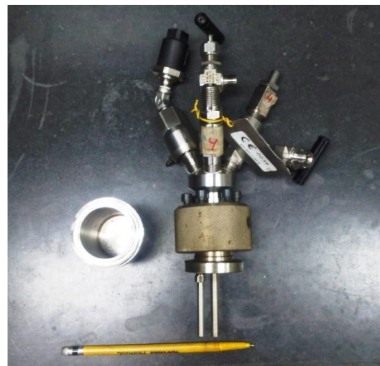
b) Vista del cabezal del reactor abierto
