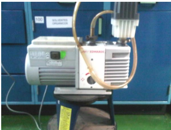
a) Bomba de vacío
