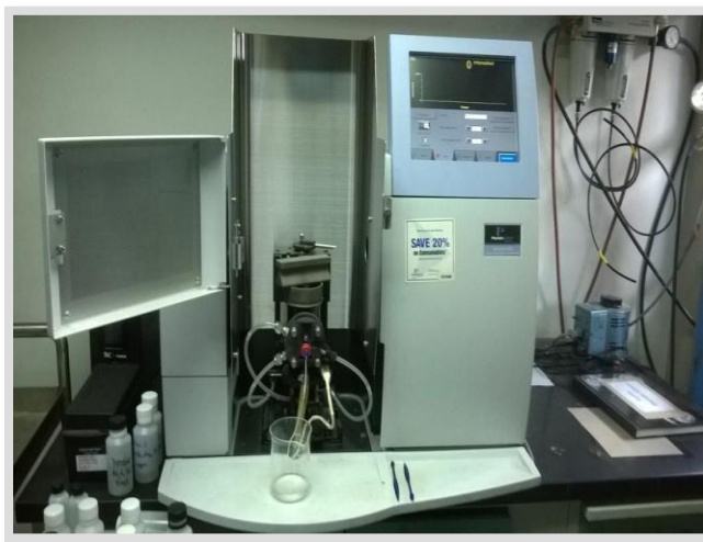
Figura 18. Equipo de espectrometría de emisión/absorción atómica utilizado para la determinación de cationes, marca Perkin Elmer Precisely, modelo Analyst 200
