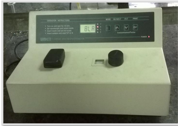
Figura 19. Espectrofotómetro de UV-Visible utilizado para la determinación de sílice disuelta ( \text{SiO}_2 ) marca UNICO 1
