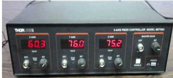
Figura 3.5. Vista frontal del Piezocontrolador MDT693 THOR LABS. En la imagen se ven los tres canales con sus displays y perillas de control de voltaje interno, así como también las entradas BNC para aplicar voltaje externo en la parte derecha se encuentra la perilla y la entrada BNC para controlar los 3 canales de manera simultánea.
