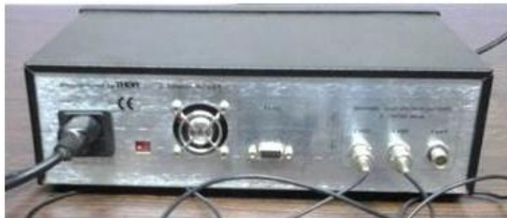
Figura 3.6 Vista trasera del piezocontrolador MDT693 THOR LABS se muestra las salidas de alimentación para los piezoeléctricos (canales X,Y,Z) y la conexión del puerto RS232.
