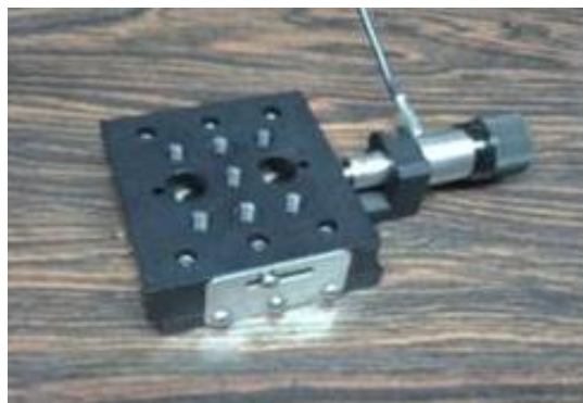
Figura 3.7 Piezoactuador con base móvil de un grado de libertad, tornillo micrométrico y cápsula contentiva del cristal piezoeléctrico.
