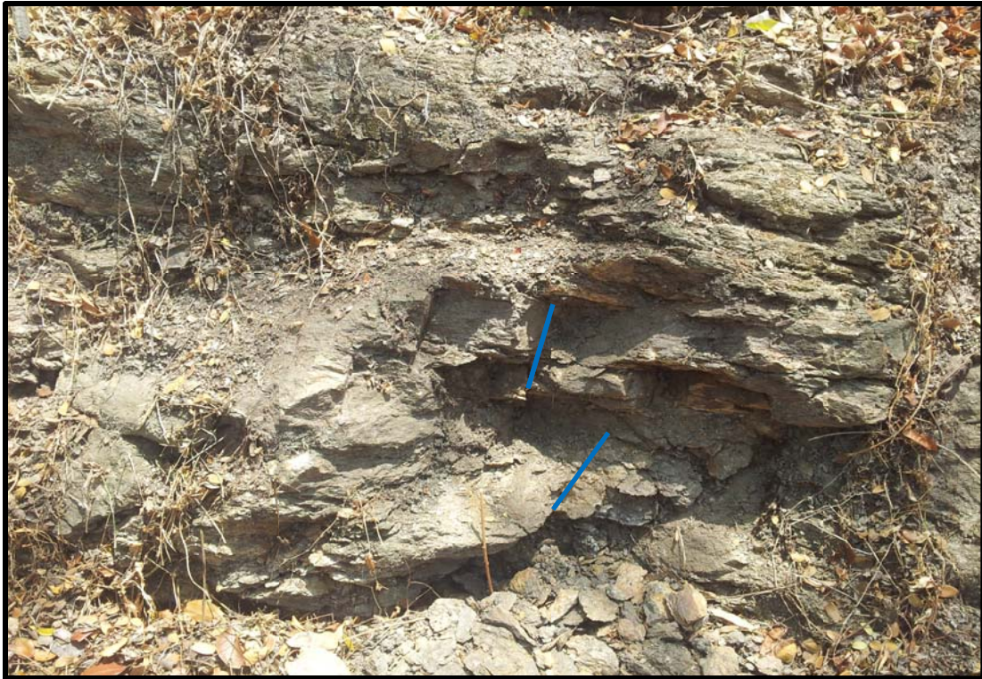
Figura 27. Afloramiento 13 y sus planos de diaclasa (líneas azules).
