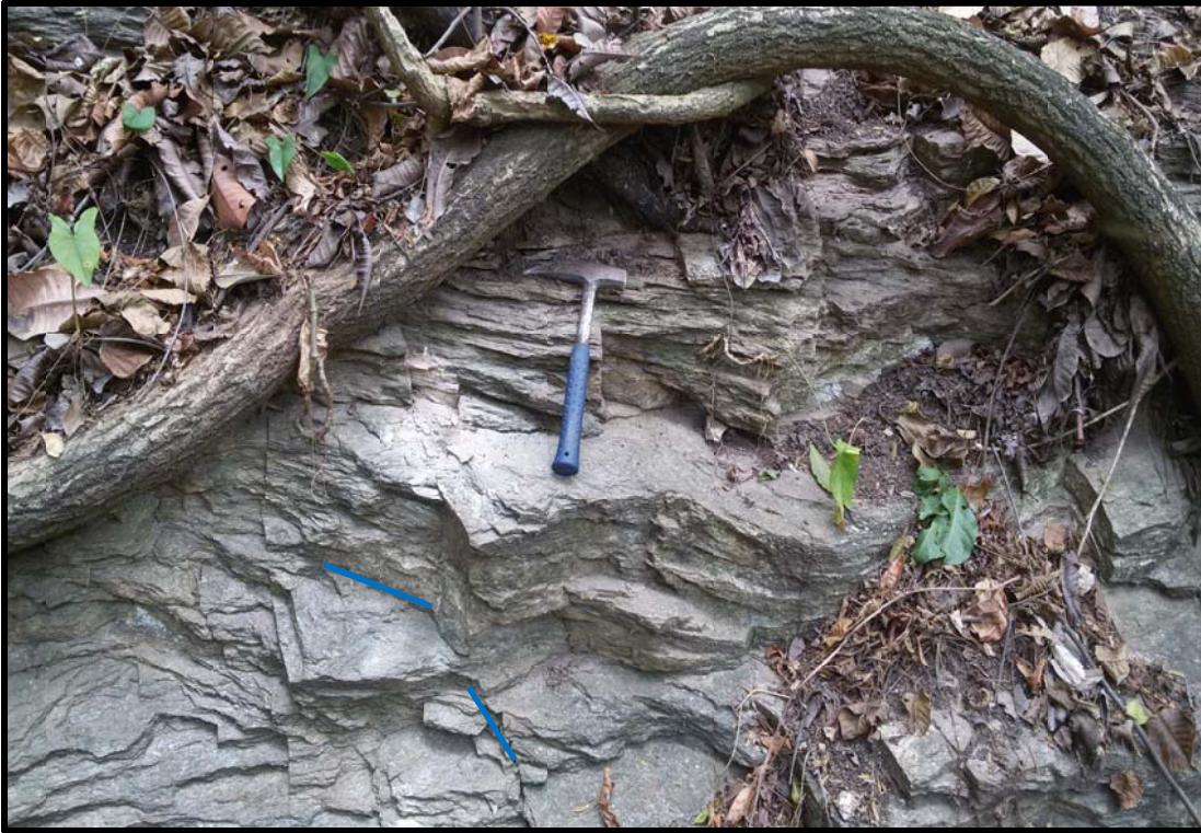
Figura 39. Afloramiento 21, las líneas azules indican sus planos de diaclasas.
