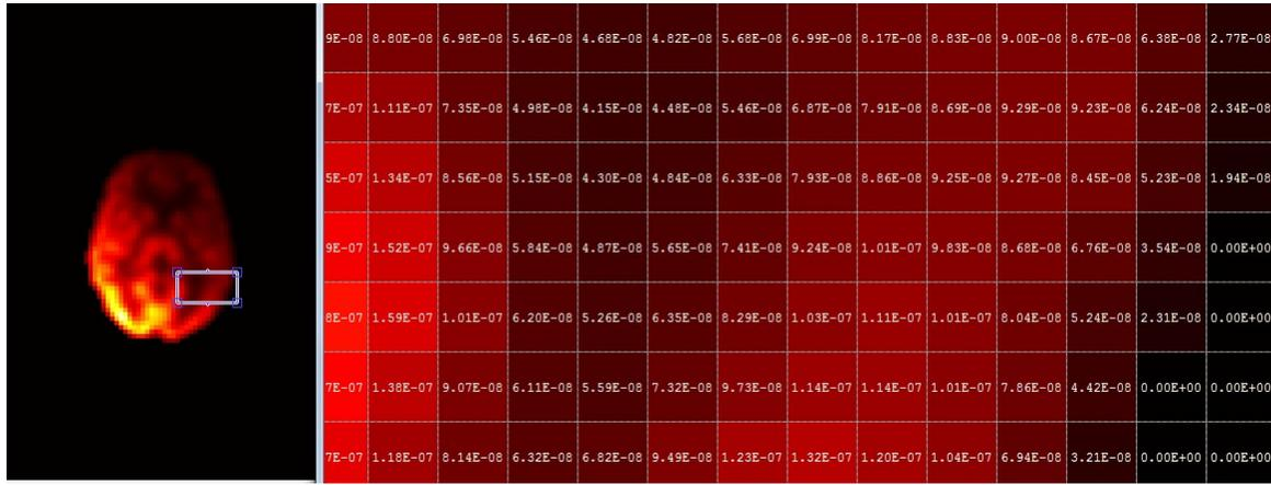
Figura 3.9: Detalles individuales del resultado de la dosis absorbida del vóxel en  $\gamma$
