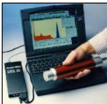
Figura 4.23. Muestra del detector de centelleo conectado al Amptek MCA8000A "Pocket MCA" y una computadora laptop ( http://amptek.com ). 16/12/02
