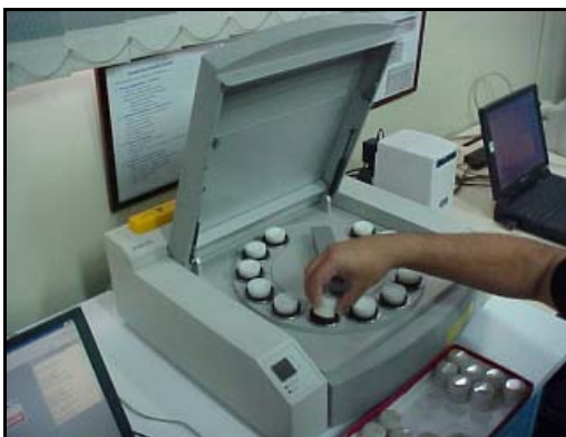
Figura 4.19. Montaje de los portamuestras dentro del contenedor del equipo Minipal.
