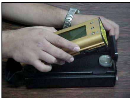
Figura 4.21. Montaje del equipo sobre la muestra en su plataforma de análisis en laboratorio.
