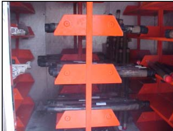
Figura 4.3. Preservación de los núcleos a -25 °C dentro de las cavas de PDVSA-INTEVEP.
