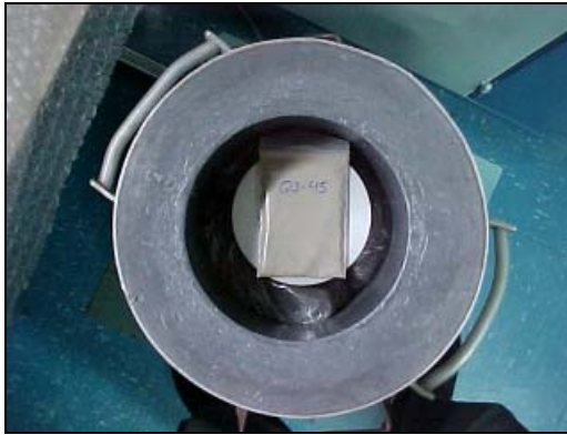
Figura 4.25. Vista superior del detector de espectrometría, dentro de los cilindros de plomo, donde se puede observar la disposición de una muestra a medir.
