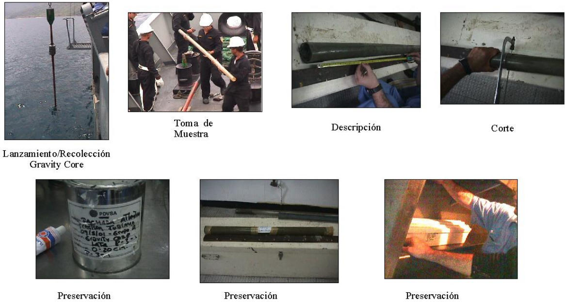
Figura 4.2. Proceso de obtención y preservación de núcleos: Gravity Core .
