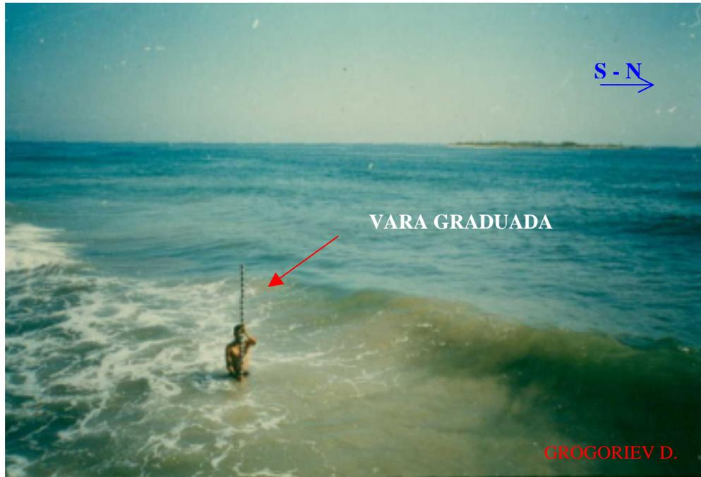
La medición del oleaje en rompientes se realiza con dos varas graduadas, una en la zona de rompientes y la otra en la zona de vaivén para con la diferencia de las medidas obtener la altura real del oleaje
