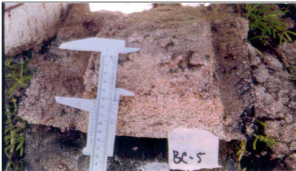
Figura 1.4. Detalle de una cuña de sedimentos extraída a partir de un “box-core”
