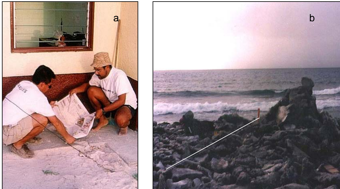
Figura 1.2. Parte de las actividades de procesamiento y recolección de datos durante el período de campo. Cuarteo de sedimentos obtenidos en la zona playera (a); Cordeleta de 5 m de longitud, empleada para el muestreo de sedimentos gruesos en la terraza de tormenta nororiental. Rumbo de la foto N10E (b).
