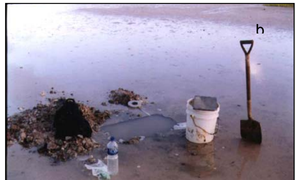
Figura 1.3. Excavación y estudio de sedimentos en calicatas. Detalle de calicata excavada en el sector oriental del Gran Roque (a); Calicata parcialmente excavada e inundada después de un breve aguacero (b).
