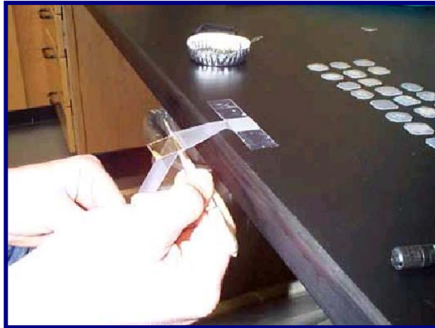
Figura 35: Separación de la mica necesaria para el montaje según la técnica del detector externo (Tomada con permiso de Garver, 2002)
