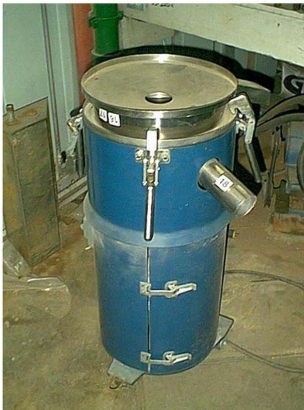
*Figura 3.8: Tamizadora Vorti-SIV, utilizada en el SASMP.*
