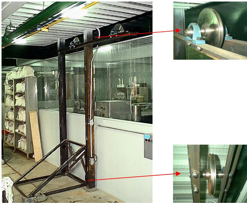
*Figura 3.9: Detalles del montacargas construido para el SASMP.*
