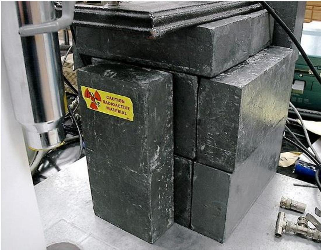
Figura N° 6.- Imagen que muestra el tipo de láminas de plomo para transportar material radiactivo, (ejemplo capsulas de cobalto 60), así como los símbolos de precaución que deben llevar en un lugar visible.
