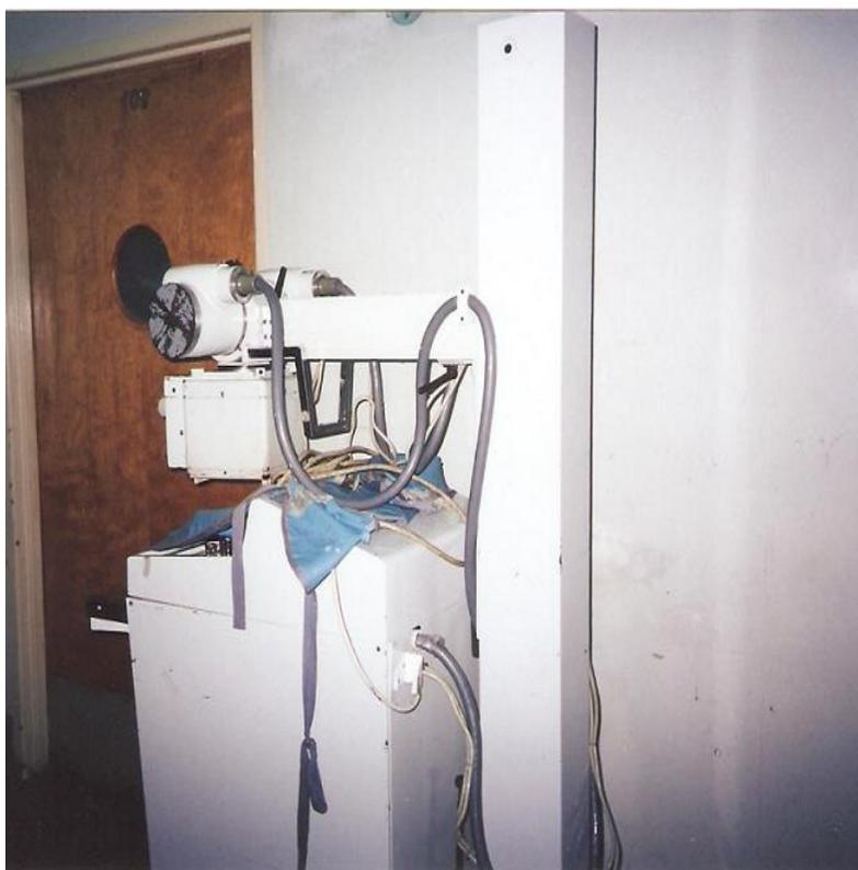
En la fotografía se puede observar que el peto que está colocado sobre el equipo de RX portátil está totalmente deteriorado. Este peto o delantal de plomo es uno de los medios de protección con lo que debe contar los Técnicos Radiólogos en el momento de la toma de estudios. Asimismo se observa el deterioro del propio equipo. Imagen tomada en la Morgue de Bello Monte.
