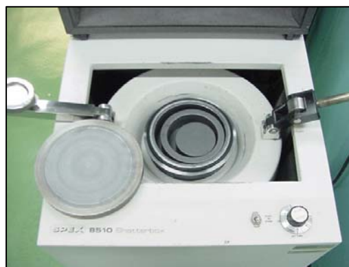
Figura 26 Equipo SHATTERBOX, con morteros de tungsteno
