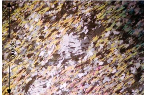
Figura 51: Fotomicrografía mostrando foliación envolviendo cristales, Nícoles cruzados Objetivo 2,5, Ocular 12,5
