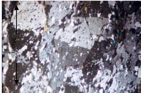
Figura 53: Fotomicrografía mostrando cristales de albita con múltiples inclusiones, Nícoles cruzados Objetivo 2,5, Ocular 12,5
