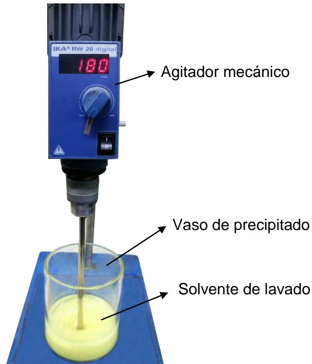
Figura 7. Montaje experimental del lavado de azufre en agitación mecánica
