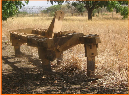
Implemento usado para subsolar el suelo
