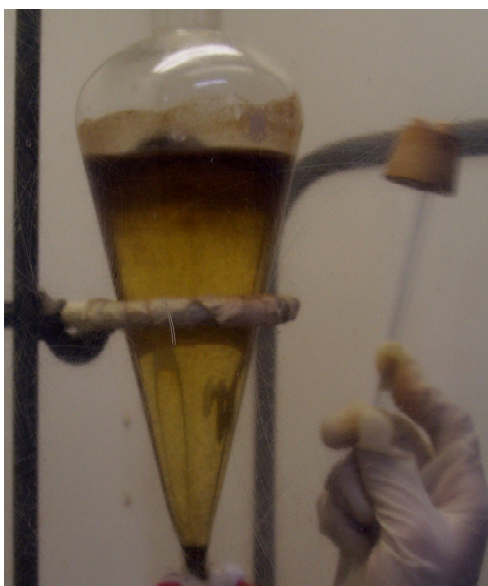
Figura A3. Agitación del líquido y el sedimento para contribuir con la decantación y separación.
