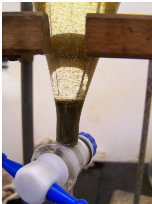
Figura A4. Minerales pesados decantados en el bromoformo. Los minerales livianos se mantienen flotando en la superficie del líquido.
