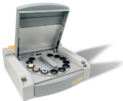
Figura A6. Equipo de fluorescencia de rayos X marca Philips modelo Minipal 2 empleado en este trabajo para el análisis elemental
