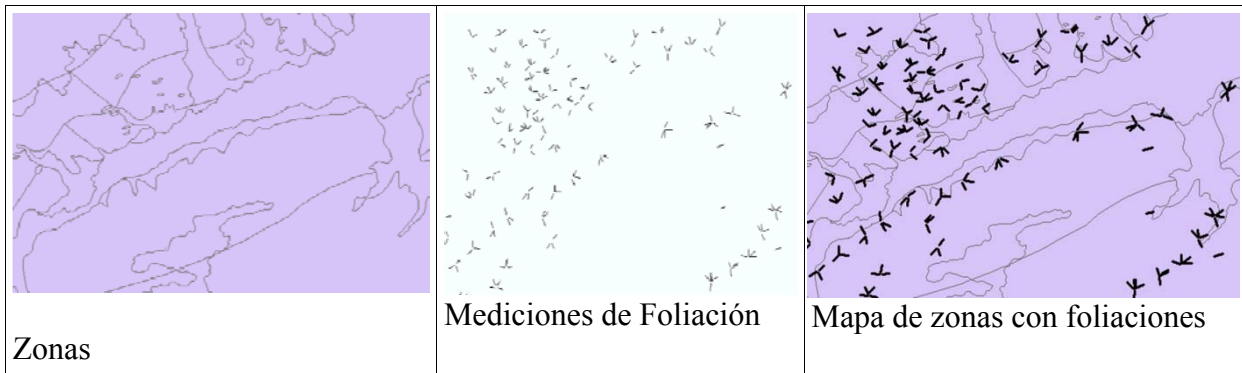
Figura 4.3.4 Partes integradas para obtener el mapa de promedio en foliaciones de acuerdo a las zonas litológicas
