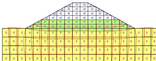
Figura 6.3 Deformación del terreno después de un llenado parcial (SIGMAW Engineering Book)
