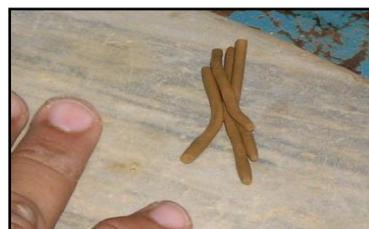
Figura 5.5. Determinación del Límite Plástico
