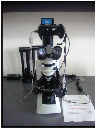
Fig. 3.8 Microscopio Olympus modelo CX31 (vista de frente)
