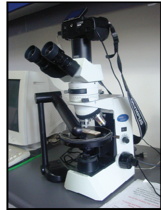
Fig. 3.10 Microscopio Olympus modelo CX31 (vista con la lámpara halógena)
