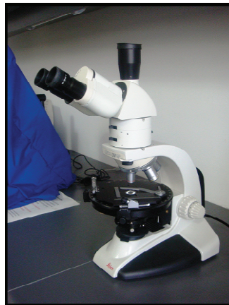
Fig. 3.12 Microscopio Leica modelo DM EP (vista de perfil)
