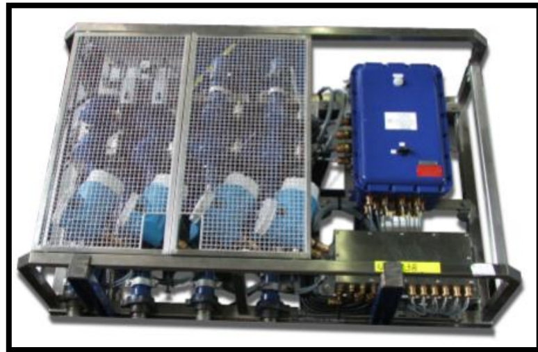
Figura 15 Estante de Medición de aditivos líquidos [10] .
