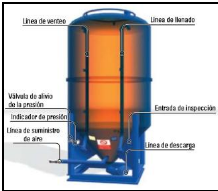
Figura 7 Tanque de Presión o Silo [7] .
