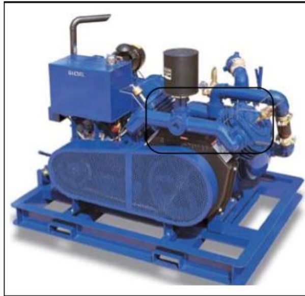
Figura 19 Compresores de baja presión [7] .
