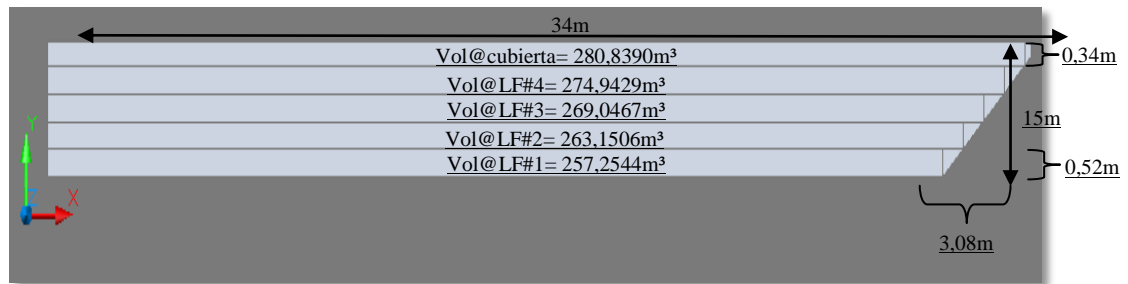
Figura 60 Volúmen desplazado por Líneas de Flotación del Casco de la Gabarra de Cementación D-1992.
