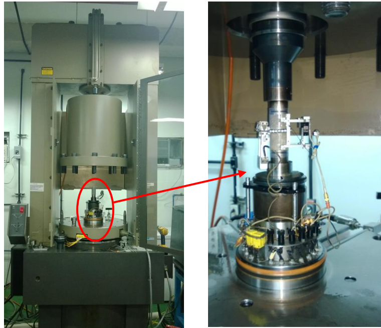
Fuente: Este estudio Figura 52. Montaje de muestras en la celda triaxial MTS-815.
