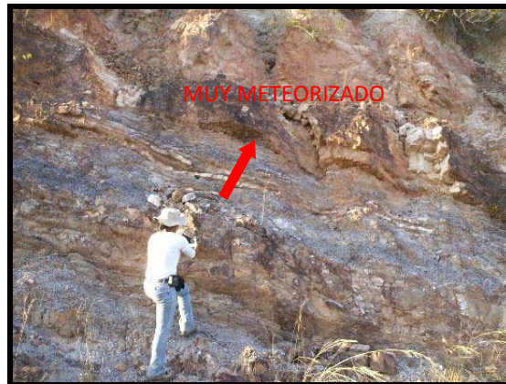
Figura 58 Secuencia de arenisca – lutita, muy meteorizada. Afloramiento 29. Sector Zurita. (Vista en campo) N7°W.
