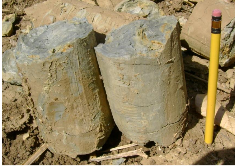
Figura N° 3.1. Núcleo de lutita extraído de la perforación 311+770.
