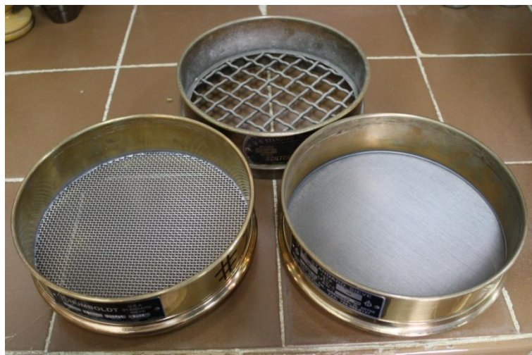
Figura N°1.2. Tamices con aberturas de distintos tamaños.
