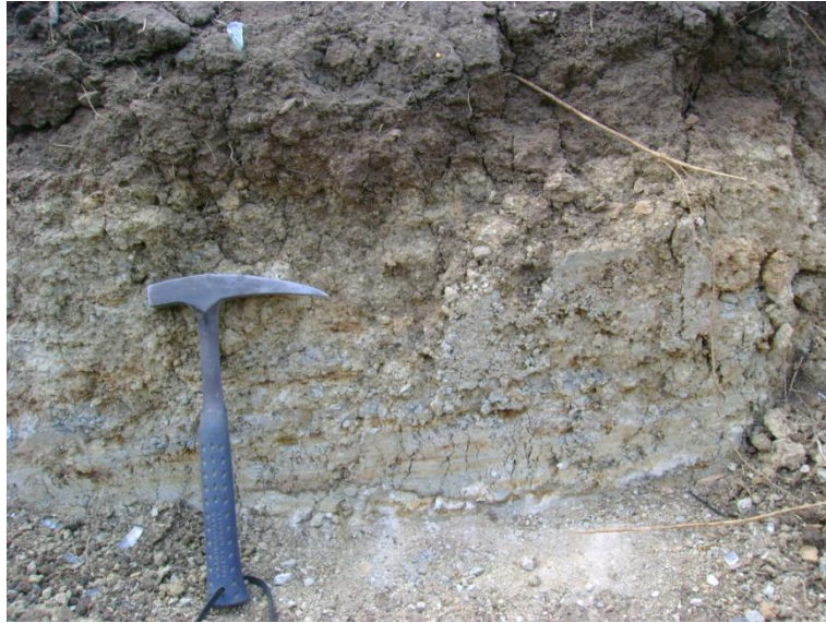
Figura N° 3.8. Afloramiento en corte de carretera cercano a la progresiva 320+640. Se observa contacto entre suelo residual y la arcilita. (Orientación S 35° W).
