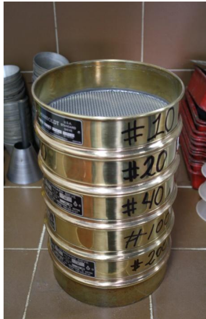
Figura N°1.3. Torre de tamices
