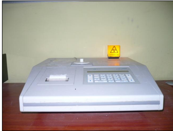
Figura 9 Foto Unidad de estudios de fluorescencia de rayos x marca OXFORD
