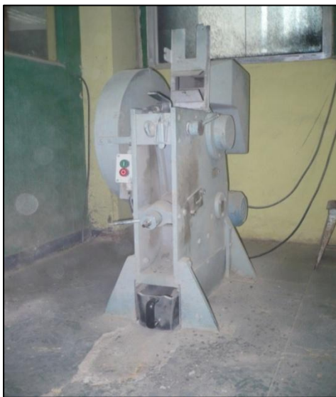
Figura 3 Foto moledora de garganta G SIST
