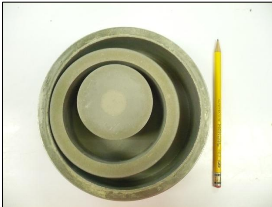
Figura 5 Foto cámara de discos moledora herzog
