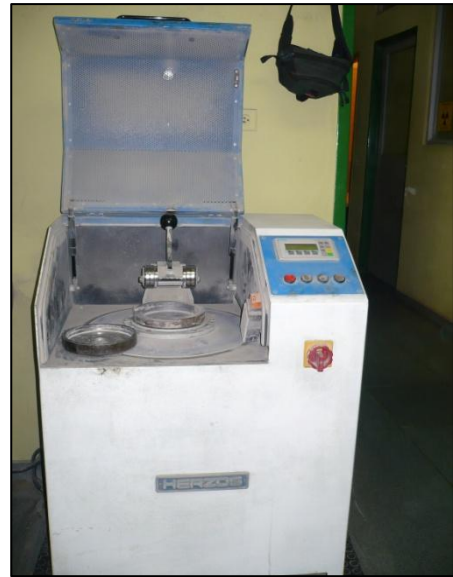
Figura 6 Foto moledora de anillos marca herzog
