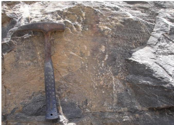
Figura # 41. Estrías de falla con orientación N30-40W, en el nivel 570 del frente de explotación.
