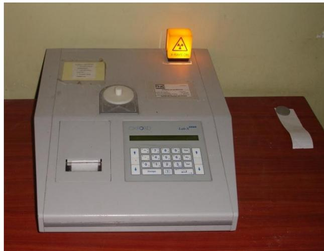
Figura # 9. Espectrómetro XRF Oxford IB-LABX3000.
