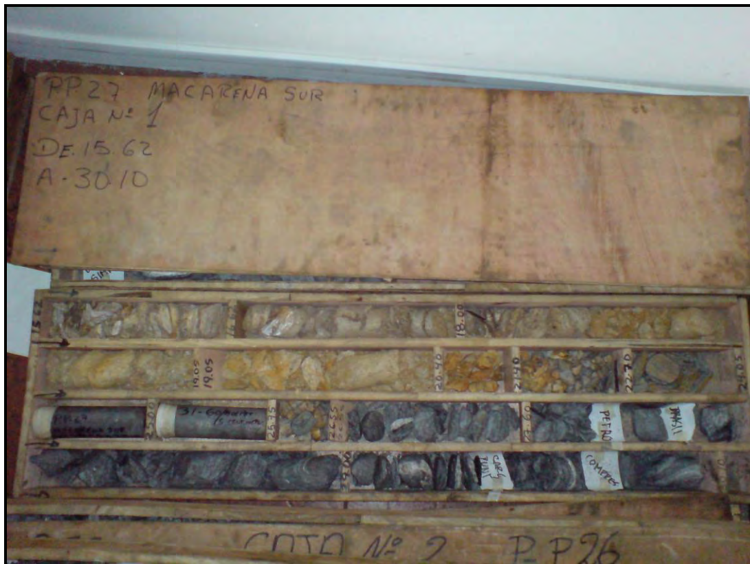
Fig. 18 Muestras obtenidas de perforaciones geotécnicas a rotación.
