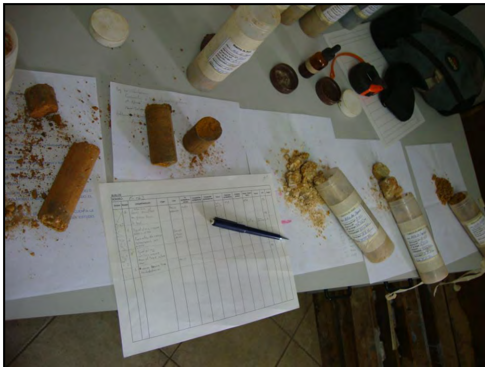
Fig. 17 Descripción de muestras provenientes de perforaciones geotécnicas.
