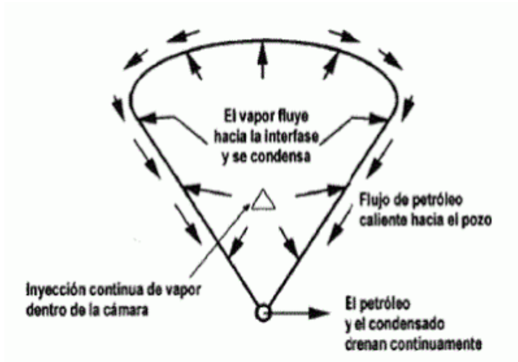
Figura 2.5. Sección Transversal de la cámara de Vapor SAGD [1]
