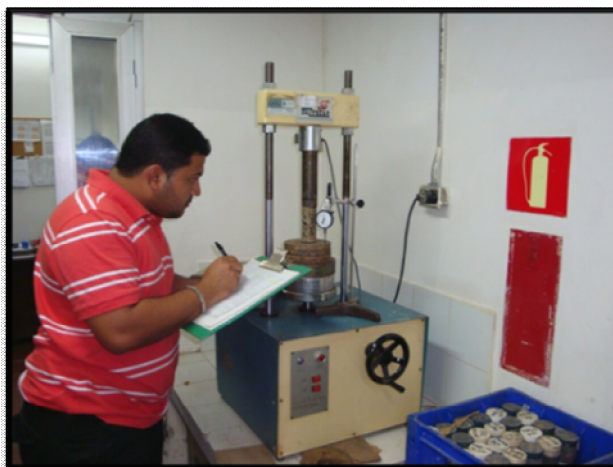
Figura N° 5.9 Aplicación de carga vertical y toma de lectura
