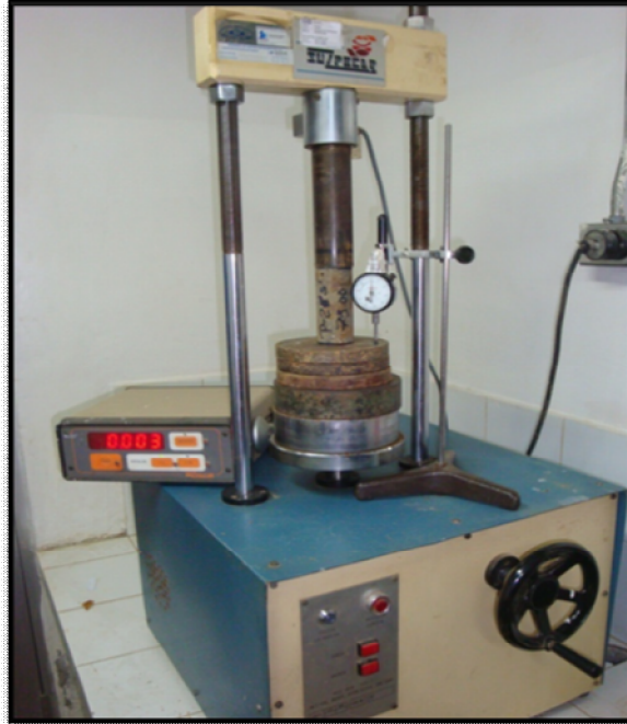
Figura N° 5.5 Equipo de Ensayo Uniaxial o de Compresión Simple en Roca, marca SUZPECAR, modelo MEM-100/3, con capacidad de 80.000 KN. Propiedad del Laboratorio de Geociencias de la Empresa Geohidra Consultores C.A
