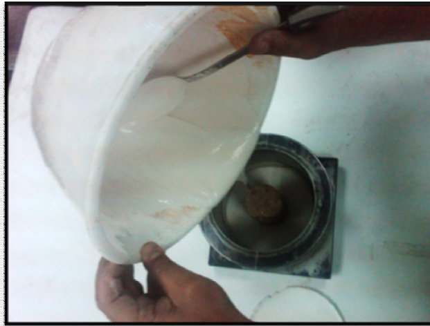
Figura N° 5.26 Montaje de la muestra en el material encapsulante (Yeso dental)
