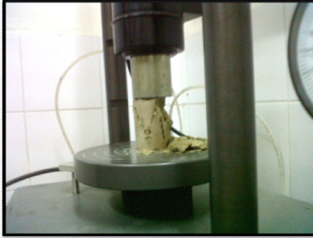
Figura N° 5.10 Vista donde se muestra la rotura de la muestra luego de ser sometida a un incremento de carga vertical.
