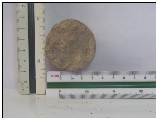
Figura N° 6.3 Muestra de limolita arcillosa correspondiente a la perforación P – 3SO, en la cual, se observa una mayor proporción de sedimentos finos (arcillas y limos), cristales de cuarzo y particularmente algunas micas.
