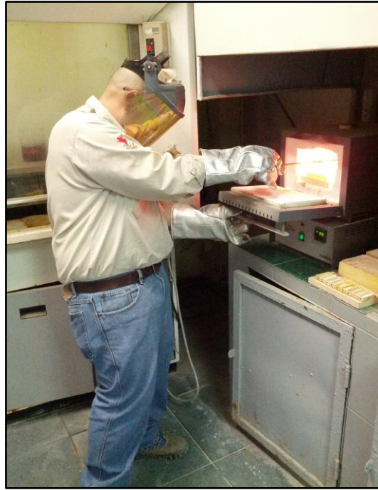
Fig 18. Horno donde se llevan las muestras para quemar los carbonatos totales.
