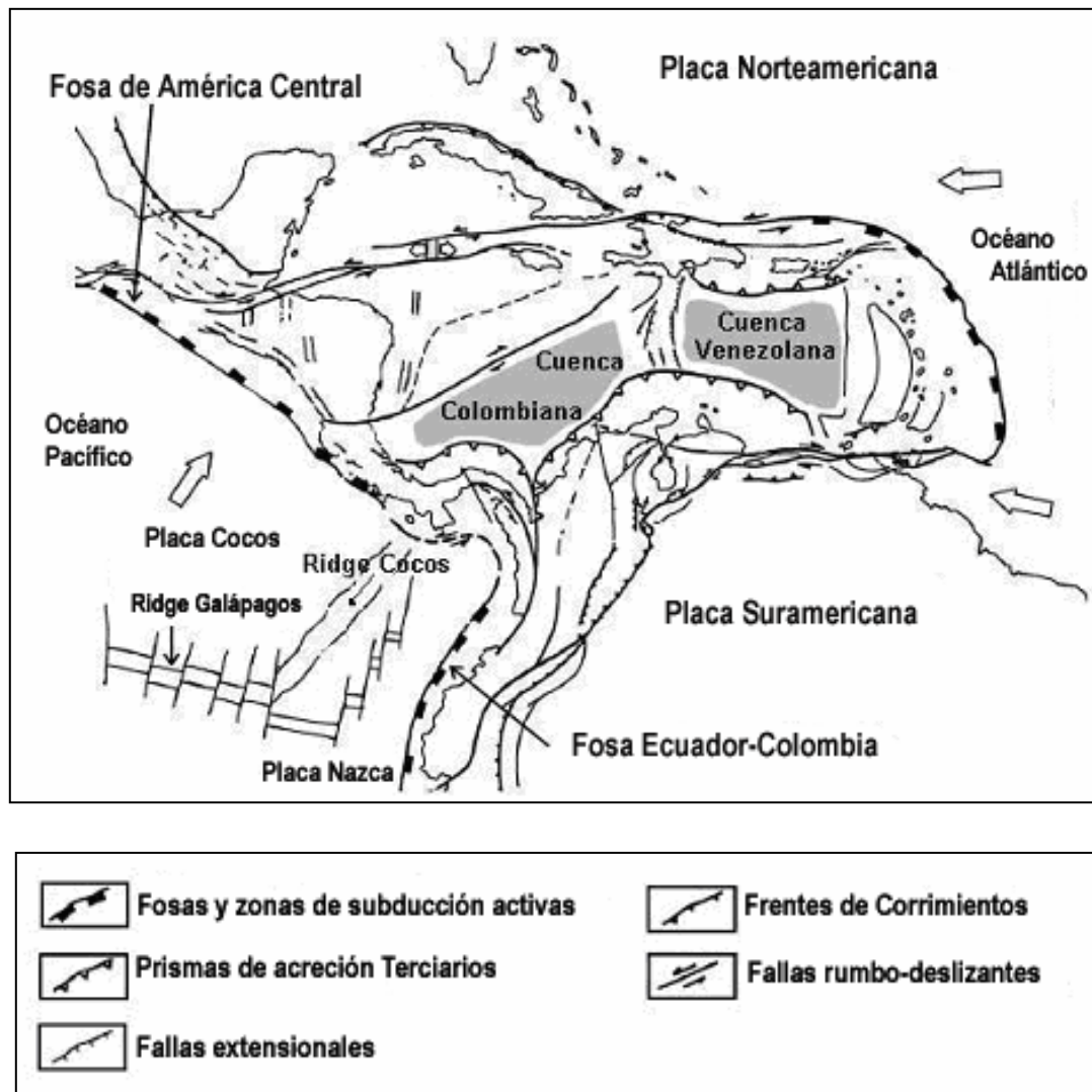
Figura 12: Situación limítrofe actual del Caribe. Las flechas muestran las direcciones de movimiento de las principales placas (Tomado de Giunta et al. , 2003).
