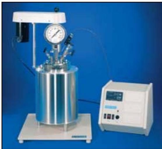
Figura N° 24. Reactor marca Parr, modelo 4843, empleado en el tratamiento del crudo de la fosa
