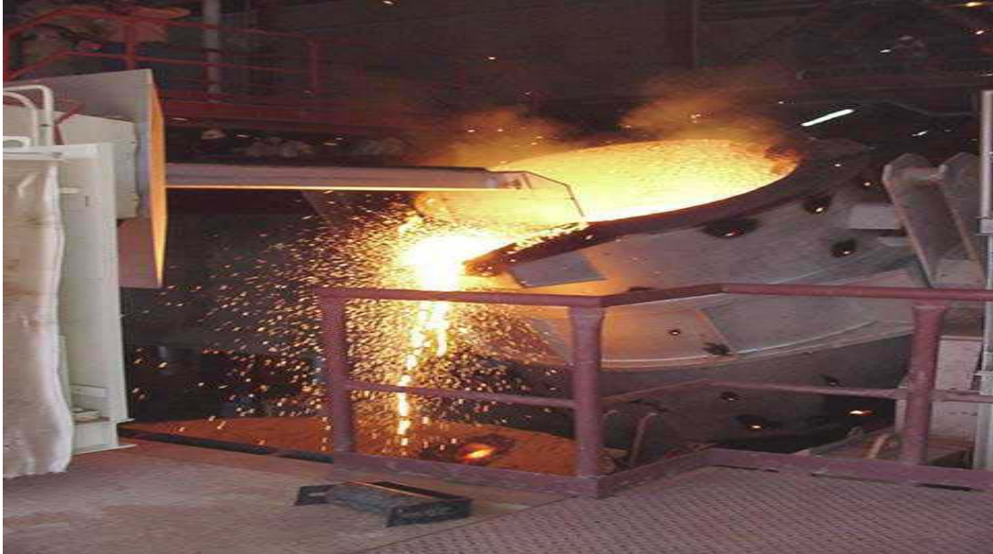
Anexo N° 17. Desescoriado del metal. Colada de metal en el tanque de granulación.
