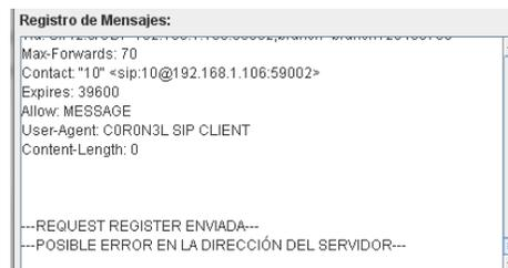
Figura 45. Error en la conexión con el servidor SIP.
