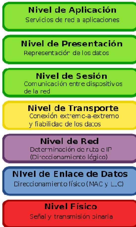
Figura 1. Pila del modelo OSI.
