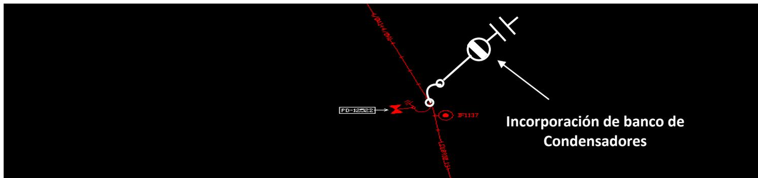
Figura R.52. Ubicación de 1 banco de condensadores de 300kVAr reubicado en el anteproyecto de desincorporación de 3 bancos de condensadores de 300kVA, reubicación de 2 bancos de condensadores de 300kVA e instalación de 2 bancos nuevos de 600kVA para el CRY\_A03.
