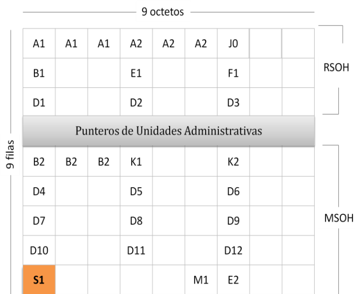
Figura 4: SOH de la trama STM-1. Recomendación 707. Serie G. ITU-T.
