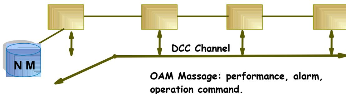
Figura 22: Canal de comunicación de datos [13]
