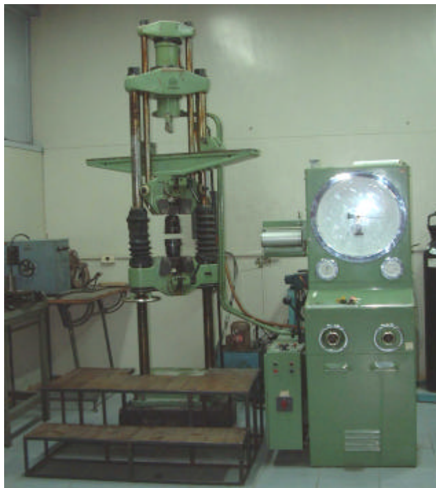
Figura 2.16.- Máquina universal “LOSENHAUSEN”, modelo UHP 20, utilizada en los ensayos de doblado de la junta soldada.
