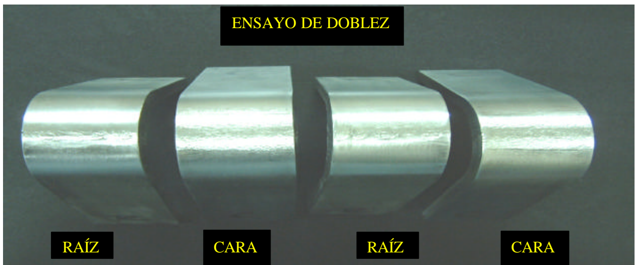
Figura 4.4.- Probetas obtenidas del ensayo de doblez de Acero Inoxidable Austenítico AISI/SAE 304, soldadas con un electrodo ER 308L-Si.
