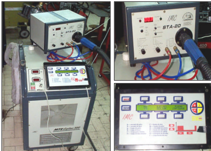
Figura 2.6.- Equipo de soldadura MTE DIGITEC 450 con su sistema de alimentación y control.
