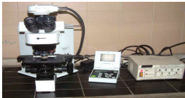
Figura 2.1.- Microscopio Óptico Olympus BX60 junto a la cámara digital Olympus DP12.
