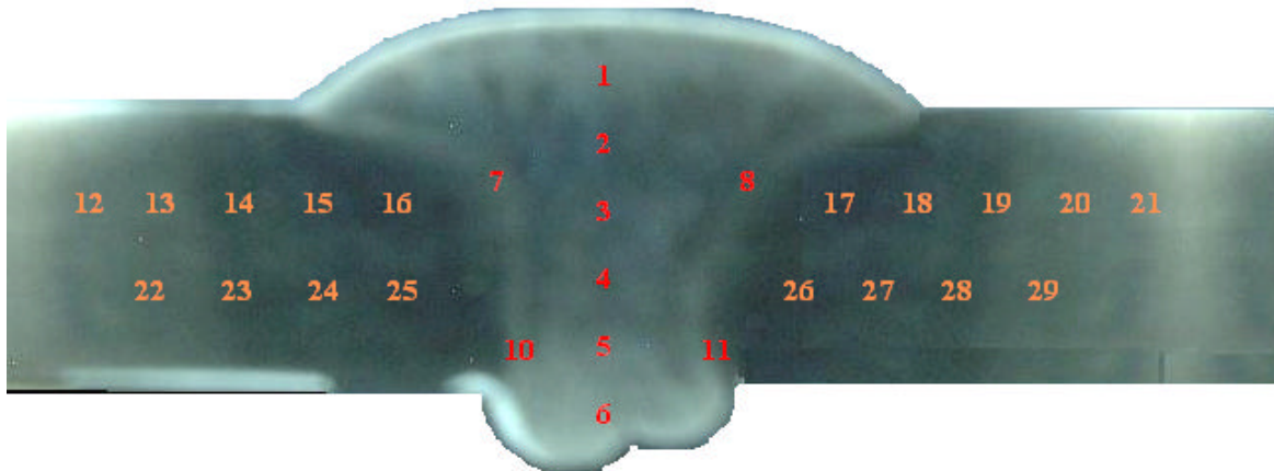
Figura 2.12.- Esquema representativo de los lugares en los que se medirá la dureza.
